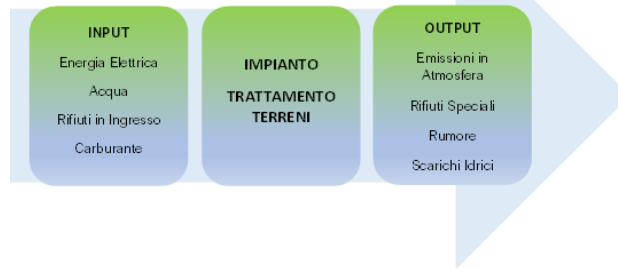
Figura 10 - Schema degli aspetti ed impatti ambientali originati dall'impianto soil washing
